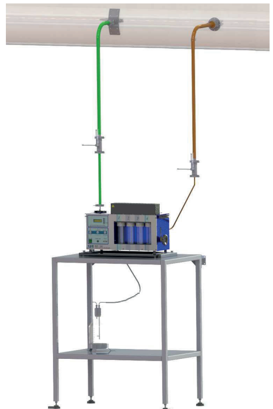
Barboteur Tritium MARC7000 en prélèvement sur émissaire de rejet
